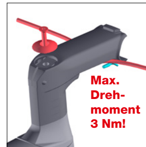
Obere Kappe montieren.
