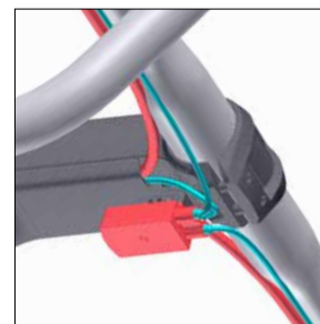
Instala la caja de conexiones Di2 (opcional)
