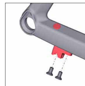
Bloqueo del cable del desviador trasero
