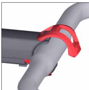
Instala la placa frontal y el protector de esta y comprueba que la abrazadera superior para placa frontal tipo 'puzzle' se acopla de forma segura
