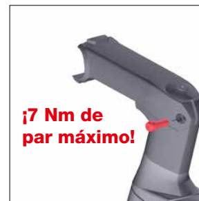
Instala el tornillo de la abrazadera del tubo de la potencia (se necesita grasa)
