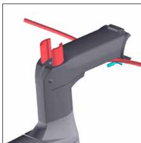
Instala la potencia y las inserciones del tubo de la dirección
