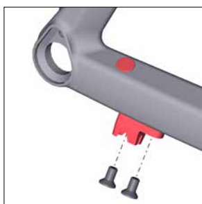
Bloqueo del cable del desviador trasero
