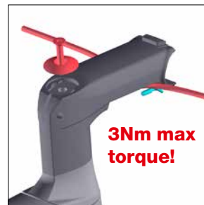
Install top cap
