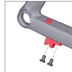
Rear derailleur cable stop
