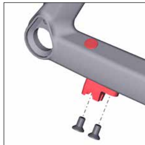
Rear derailleur cable stop
