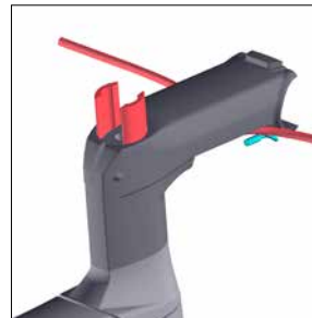
Lenkervorbau und Einsätze des Steuerrohrs montieren
