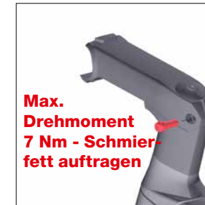
Klemmschraube des Steuerrohrs des Lenkervorbaus montieren
